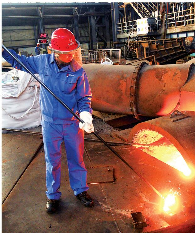
炼铁厂近日组织生产技术人员、岗位操作人员对原燃料、设备运行状况、操作工艺等环节进行严格控制,消除造成铁水质量波动的因素,不断提高铁水质量,实现低硅冶炼。图为职工正在进行铁前取样。 刘君 摄
