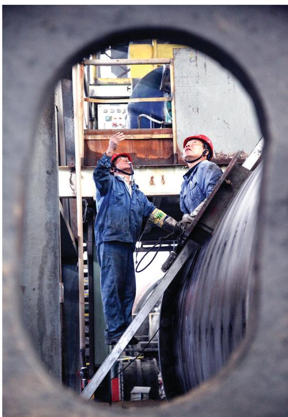
(上接第一版)一旁的球团部主任张宝林告诉记者,回转窑结圈处置是降本增效重点攻关项目。2014年6月以前,平均一个半月就要停产36个小时专门处理结圈。在攻关项目时,职工们做出了这样的扒块工具,在生产间隙,将扒块工具从各个口伸进去,直接钩铲结圈,这样一来避免了进入窑内作业的麻烦,二来也不必专门为清理结圈而停产,一举两得的好办法。这一改进,使得回转窑从2014年三季度开始实现三个月连续正常生产,大的清理结圈周期已经和季度检修同步,安全效益和经济效益都很可观。
