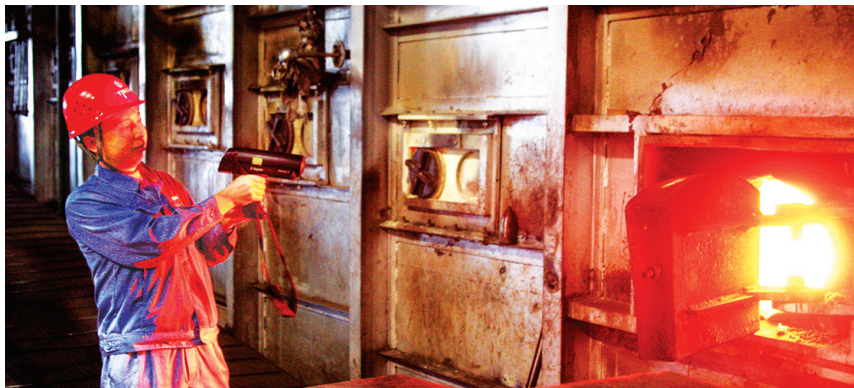
日前,不锈钢管公司组织员工开展“新常态下的太钢路在何方”主题大讨论,激发全员在新常态下的责任意识和危机意识,要求全员创新创效,精细工作,进一步提升产品质量,满足用户需求。图为职工正在测量坯料出钢温度。 刘君 摄 吕茹 文
