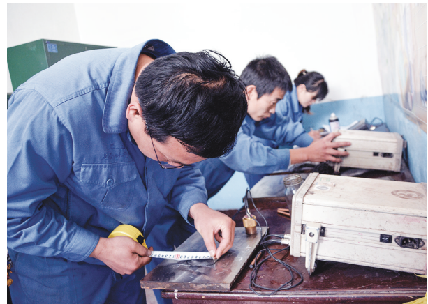
为提升复合板探伤工探伤检验技术,近日,复合材料厂计量检验室组织探伤工技术比武。图为探伤工在实践操作现场精心操作超声波检测仪。 白旭峰 摄
