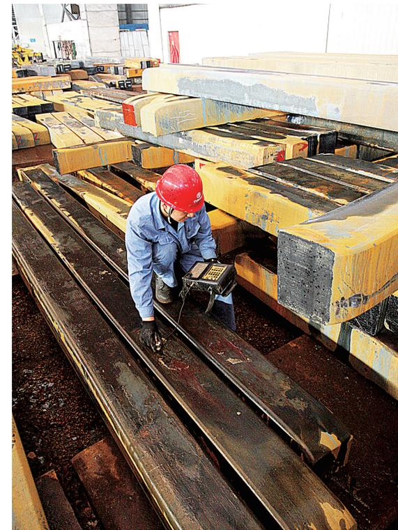
今年以来,型材厂转变质量管控思路,将质量管理重心下移至班组,完善岗位质量责任制,使产品质量得到稳步提升。图为职工正在对产品进行探伤检测。
