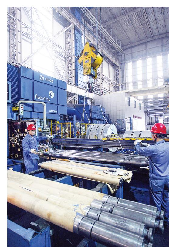
不锈冷轧厂在TPM(全员生产维护)推进过程中不断完善日常点检,岗位人员通过日常点检及时发现问题,及时处理问题,确保机组稳定运行。图为操作人员正在检查更换轧辊。
