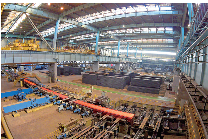
在刚刚过去的2014年,炼钢二厂通过开展提高钢种全成分命中率攻关活动,采用六西格玛等质量改进方法,对影响精控命中率的原因进行系统分析,针对性制定实施改进措施,碳钢成分命中率得到大幅提升。图为该厂连铸出坯现场。王旭宏 摄
