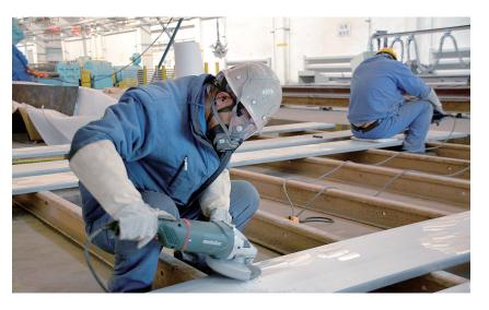
今年以来,复合材料厂在矿产品和复合板生产上,持续完善质量改进机制,下 功夫攻克影响产品质量的重大技术难题,全面提升职工的精细化操作水平,致力 于培养工匠精神,尽责至善,尽善尽美,确保技术经济指标全面提升。图为复合板 生产线职工对铝钢复合板表面进行精细修磨。 白旭峰 摄
