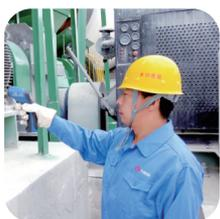
我是一名司窑工。去年,在一次回转窑窑体测温时,我测到了一处高温点,初步判断是窑内耐材脱落并迅速上报,作业区立即采取了措施,避免了损失,我也因此受到了作业区的表扬和肯定。这一件小事彻底改变了我,让我切实体会到了精心工作的价值。后来,我又陆续发现了挡轮裂纹、角落液压软管磨损、推头推杆丝扣脱落等隐患,这些隐患的及时处理,确保了设备的稳定运行,避免了设备和生产事故。我也被评为太钢鑫磊公司“金牌员工”、劳模和太钢先进工作者。
