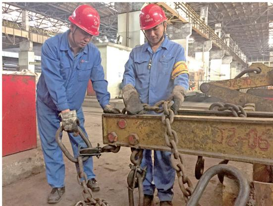
型材厂精整作业区把吊具专项检查作为安全重点工作来抓,对查出的安全隐患及时进行整治,进一步推动安全生产。图为职工对吊具进行专项检查。
