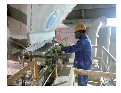
为提高职工识别、控制动态危险的意识和能力,东山矿气力输送作业区通过对岗位职工进行系统的 KYT培训和经常性的模拟训练,全面掌握危险预知训练活动的有关知识、流程和方法,并运用到生产及检修作业中,有效消除作业不规范、动作不标准造成的各类人身伤害事故。图为岗位职工进行调整料仓下料棒阀危险预知训练活动。
