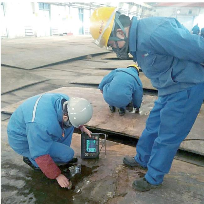
工序质量是产品质量形成的最基本的环节,它决定着产品的制造质量。复合材料厂加工精整作业区对各个工序质量实行事前事中控制、事后把关的方法,确保各个工序质量顺利实现目标。图为质检员对挖补后缺陷进行探伤检查。
