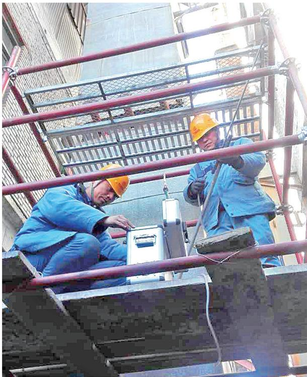
近日,尖山铁矿为使生产过程中的污染物达标排放,生产更加合法合规,该矿设备及锅炉技术人员积极进行35吨锅炉低硫煤脱硫系统试验。图为该矿技术人员正在对烟气污染物进行指标测试。
