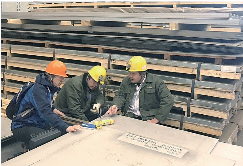
面对日益激烈的市场竞争,服务已提升为企业占领市场的重要环节。因为我公司服务人员和华东地区某日资企业现场按照欧标对热轧不锈钢开平板厚度进行复检。 吕耀南 摄
