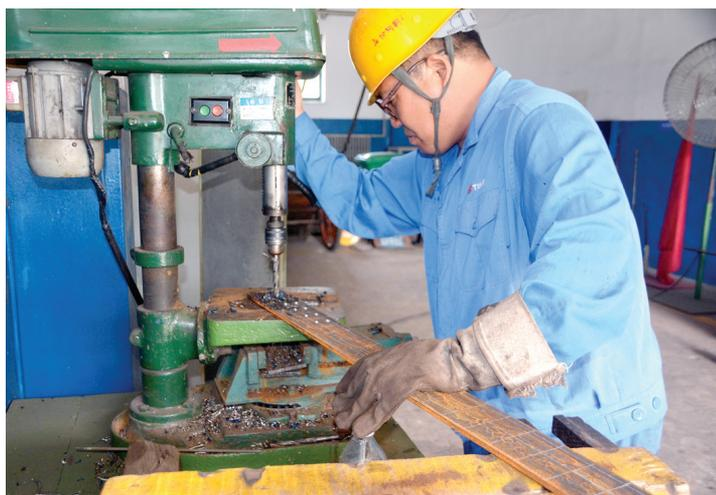
近日,复合材料厂维修作业区制作了一批边卡,用于复合前固定基、复板边部,有利于提升复合质量,减少炸药浪费。图为维修作业区职工对边卡进行打眼作业。 丰子玲 摄
