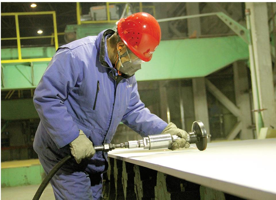
质量是企业生命,是效益的基石。不锈热轧厂将产品质量放在首位,从规范操作、提高设备功能精度、强化工序自检互检等环节入手,引导职工牢固树立“为下工序提供优质产品”工作理念。图为职工正在对钢板表面缺陷进行认真修磨。孙磊 摄
