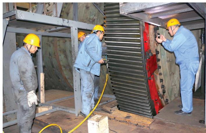
峨口铁矿强化点检定修闭环管控,以日常点检、专业检查、考核监督和服务指导等为管理手段,规范标准化检修,严格过程管理,不断提升设备精细化管理水平。图为磨选作业区职工正在对球磨机齿轮进行检修。王振华摄
