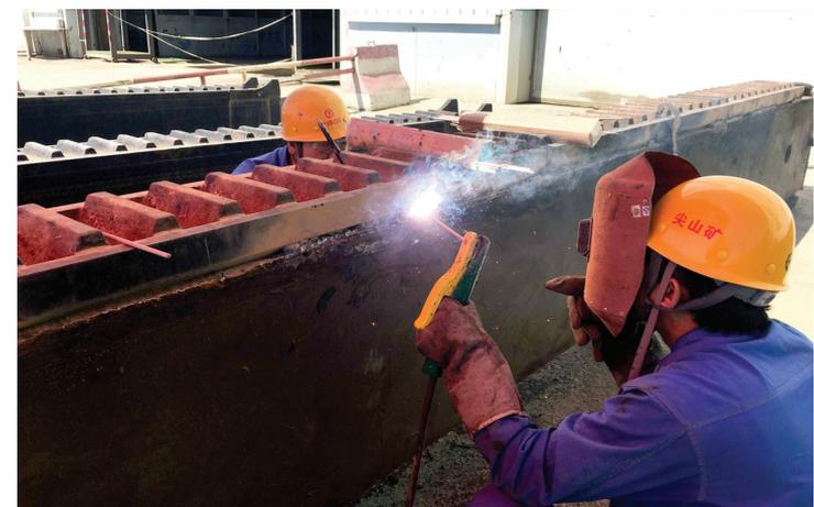
尖山铁矿检修作业区从点滴做起,认真组织开展修旧利废工作,对一些废弃的电铲铲杆进行重新修整,恢复使用,提高了设备使用率,降低了生产成本。因为检修人员正在对铲杆齿条进行焊接加固。 刘建新 摄
