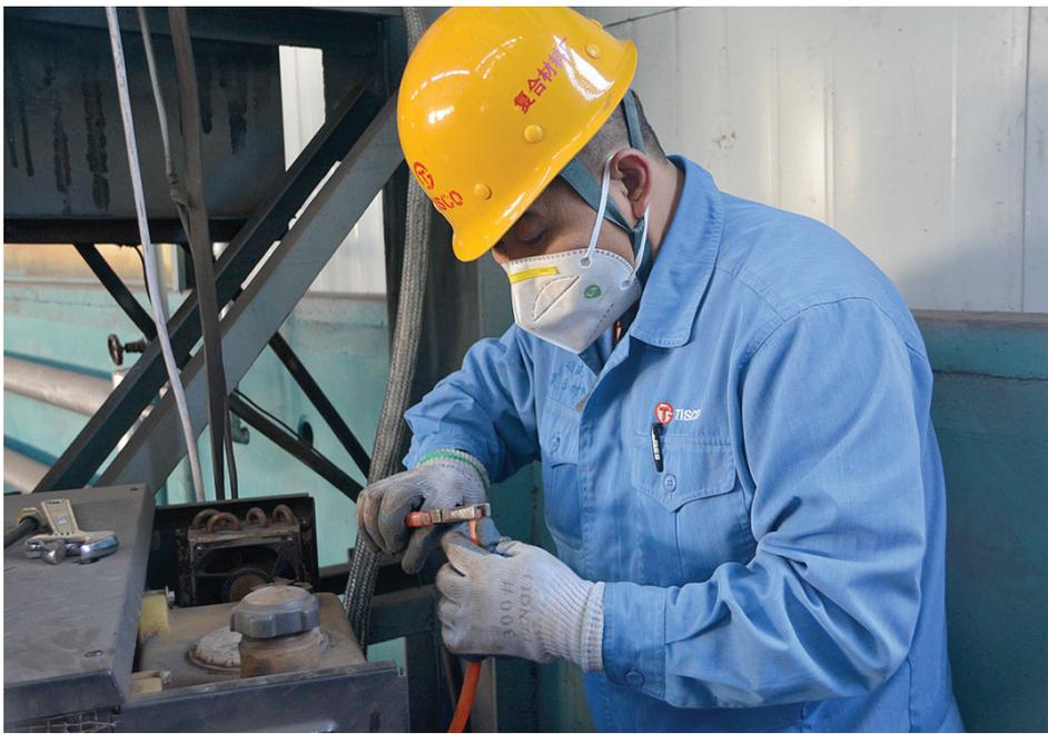
复合材料厂结合生产实际及季节特点,扎实做好防冻保温工作,对每一台设备防冻保温情况进行详细检查,对易发生跑、冒、滴、漏部位提前做好维护,保障冬季安全生产。图为职工修理等离子水箱管道。 丰子玲 摄
