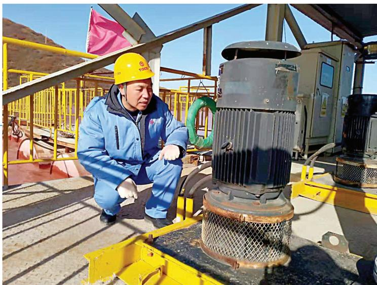
入冬以来,袁家村铁矿加大尾矿冬季安全生产专项检查力度,重点对尾矿防冻保温、搅冰器功能、电力电缆保护、冬季防火设施等进行安全检查,确保尾矿冬季生产安全平稳运行。图为职工正在检查回水泵设施。 尹军 摄
