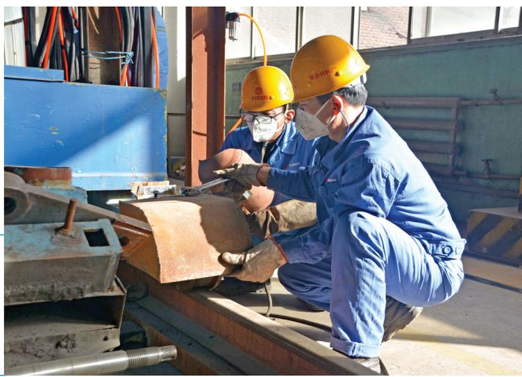
日前,复合材料厂维修作业区自主制作了3号抛光机,现正处于完善安全装置设施、抛光机试运行阶段。图为职工为3号抛光机安装大车轮护罩。丰子玲摄
