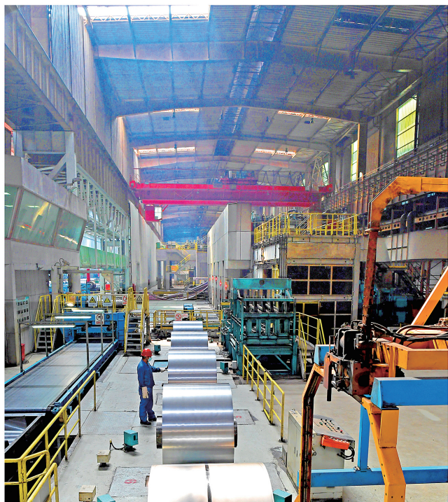
今年以来,太钢大力研发超薄规格高牌号高磁感无取向硅钢产品,进一步完善了新能源汽车用钢品种类型,全面开启了无取向硅钢“新能源”时代,产品竞争力显著增强。图为冷轧硅钢厂职工进行新能源汽车用无取向硅钢生产。 王旭宏 摄
