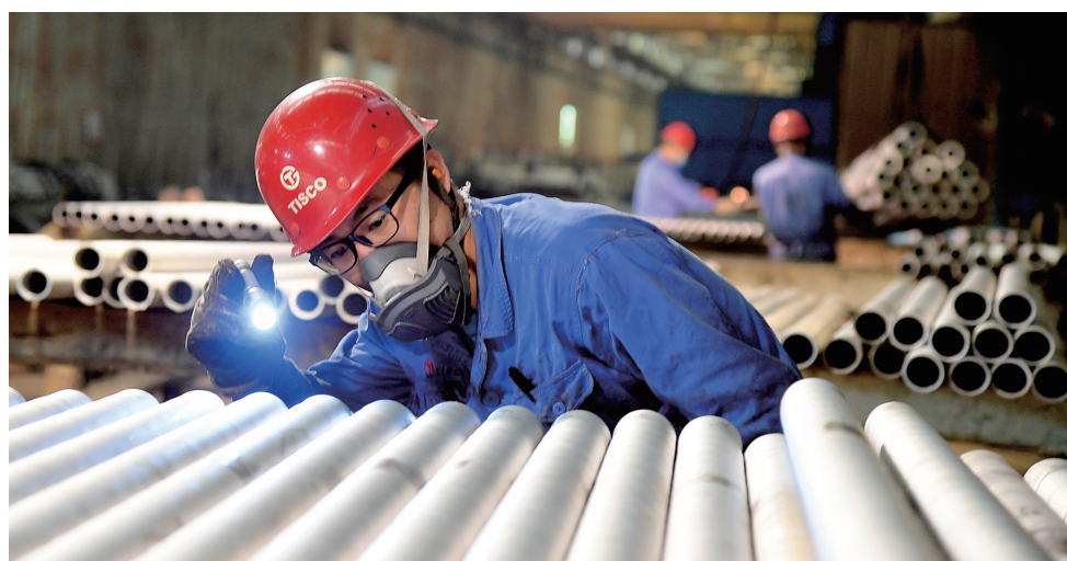
不锈钢管公司不断创新生产工艺,成功攻克技术难题,实现高等级锅炉管大批量替代进口,国内市场占有率第一。图为职工正在对高等级锅炉管进行工序质量检测。
