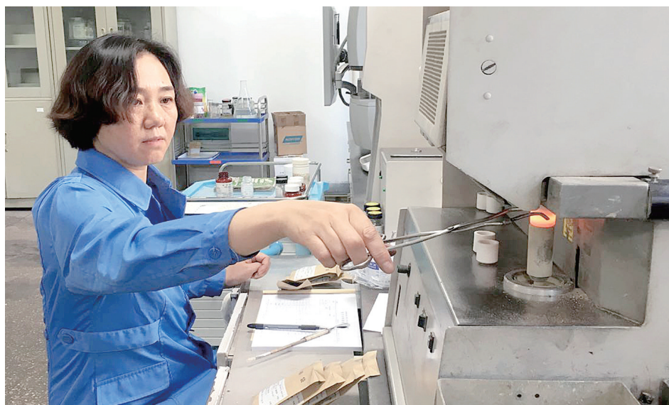
技术中心紧跟公司高质量转型发展的新形势、新要求,不断挖掘和提高仪器分析检验能力,以满足不断增加的各项生产检验任务和新产品开发的分析要求。图为操作人员专心致志操作红外碳硫仪对试样进行碳元素和硫元素的检测分析。
