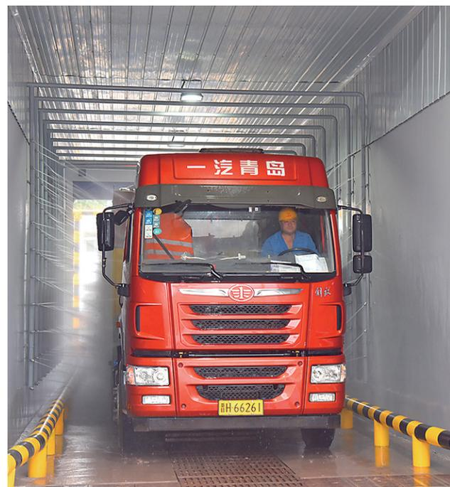
复合材料厂持续将节能环保、提质增效项目放在首位,通过建造采矿区域车辆清洗系统、实施道路硬化工程有效减少采矿扬尘,有效控制无组织粉尘排放,采矿区域环境质量得到明显改善。图为运矿车辆正在清洗车身。
