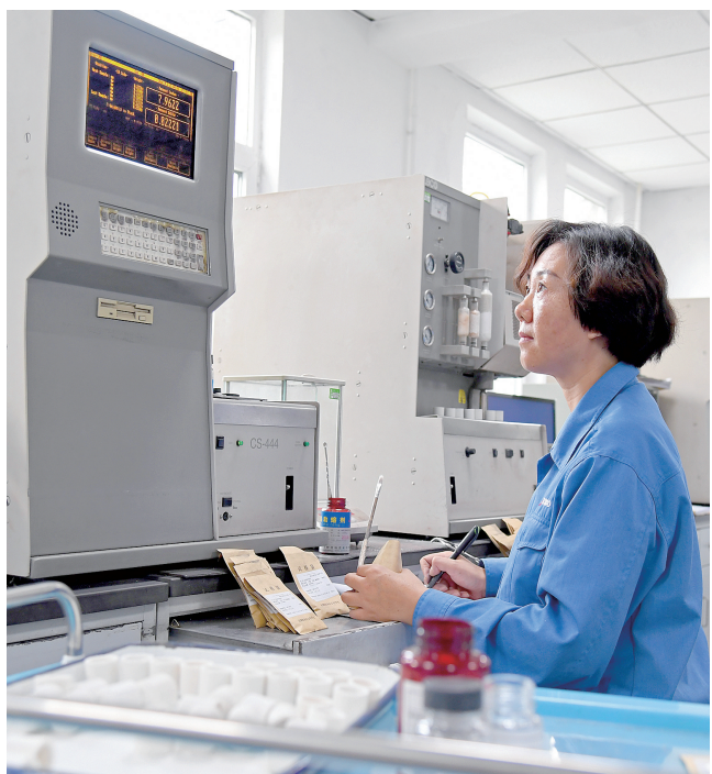
技术中心强化入厂原材料的检验工作,对合金、辅料,以及科研重点实验料等精准检验、层层把关,以稳定的分析质量保障了入厂原料品位。图为该中心化学室职工在进行原材料化学分析。
