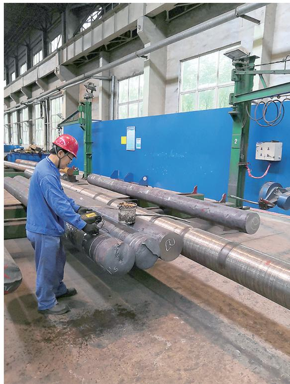
型材厂全面推进质量管理工作,落实质量管理责任,夯实质量管理基础,全员上下严格执行质量制度,形成协同保障质量提升的良好氛围。图为职工正在认真进行物料的探伤工作。 王虹 摄
