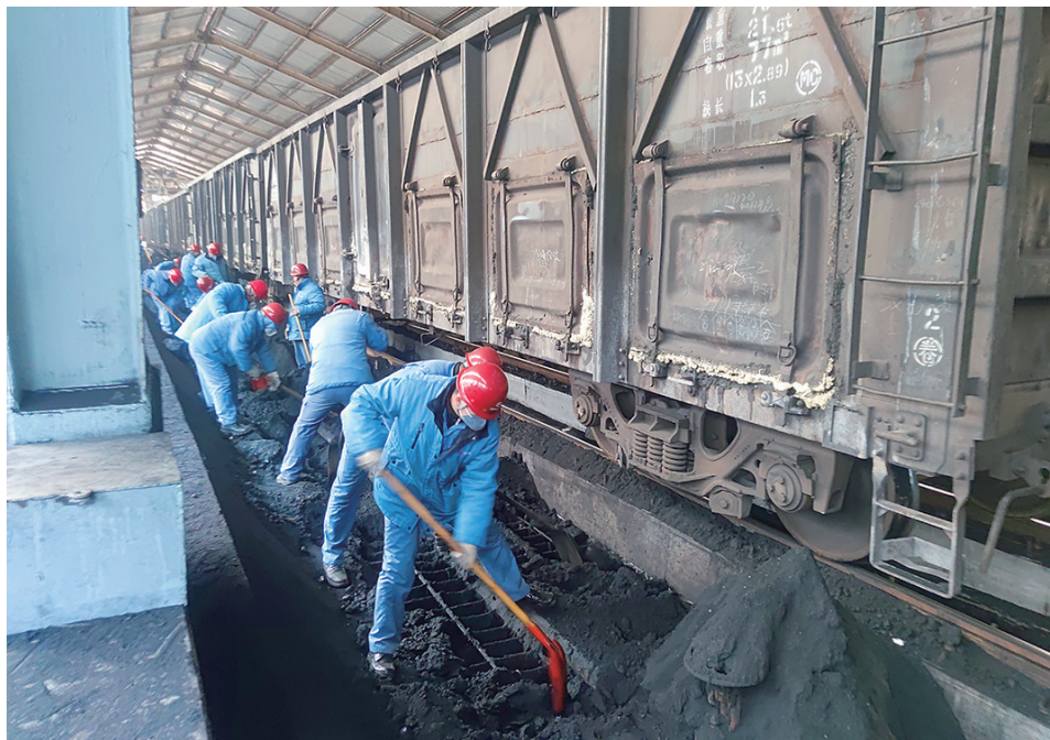
受严寒天气影响,火车煤冷冻成块,卸下的冻块煤堵住受煤坑篦子不下煤,影响正常卸煤。为保证生产任务不受影响,焦化厂积极组织干部职工打冻块,及时缓解了卸煤难题。图为职工正在打冻块。
