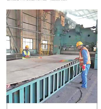
复合材料厂精整作业区从各工序入手,严格控制复合板表面质量。图为在复合板矫平之前,岗位职工清理板面浮尘。
