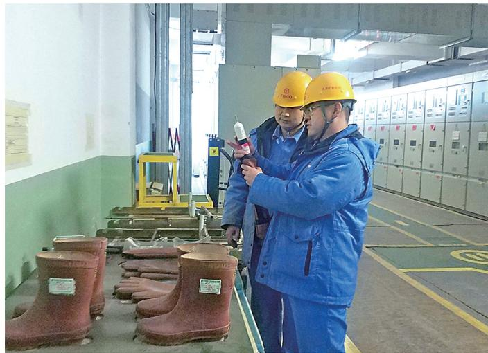
为了确保电气检修安全,大钢岚县矿业公司开展了电气工器具专项检查。图为检查高压验电器,确保检修前的安全确认可靠有效,避免发生电气安全事故。
