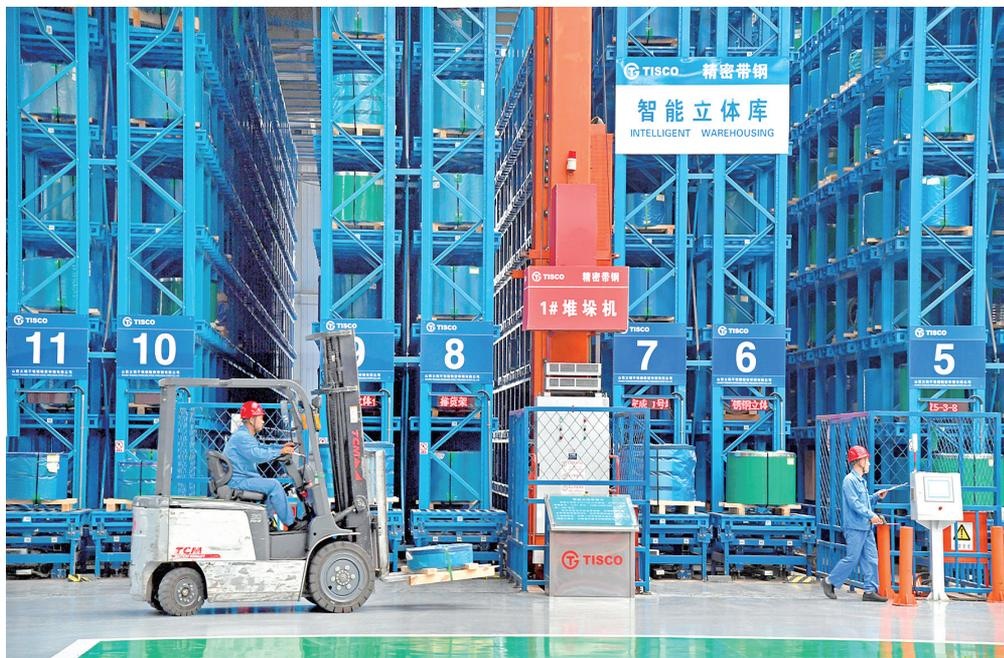
太钢精密带钢公司智能立体库系统由立体仓库、货物输送、仓库控制和仓库管理 4 个子系统组成。近 2800 个仓位,只需 1.5 分钟就能准确找到所需钢卷,具有减少占地,物流有序,查询方便,存取快捷的特点。该系统 2013 年 10 月建成投用以来,达到充分利用空间、提高货物存储量、高效出入库、节省人力资源的效果,在生产运营中发挥了重要作用。图为职工正按用户订单从智能立体库分类取存高端不锈钢产品。王旭宏 摄
