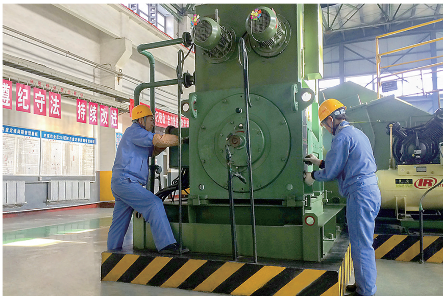
日前,太钢尖山铁矿针对季节特点,组织开展设备隐患大排查大整治工作,确保生产安全稳定。图为职工对主泵隔膜泵的电气和润滑系统进行全面检查。
