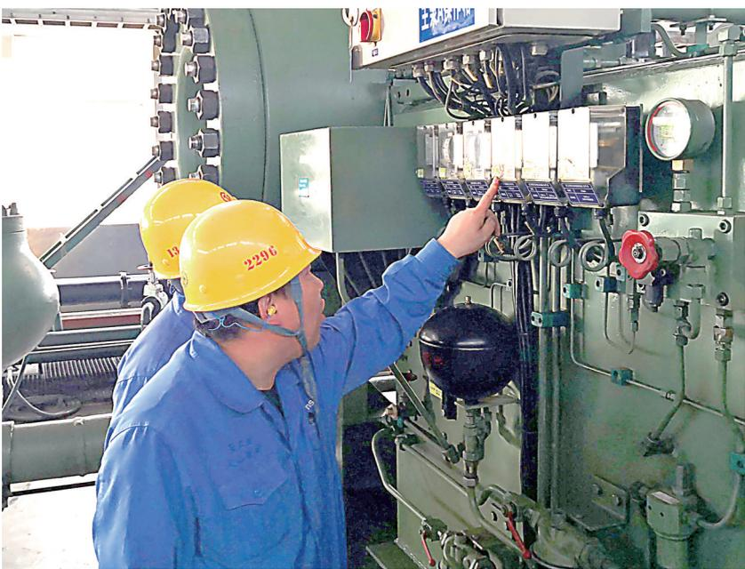
为提高设备工作效率,以稳定、高效的运行为生产提供强有力的设备保障,太钢尖山铁矿成品动力部近日组织开展设备点检跟踪活动,加强现场点检,发现隐患及时处理,将故障消除在萌芽状态。图为设备专业技术人员对隔膜泵进行点检。
