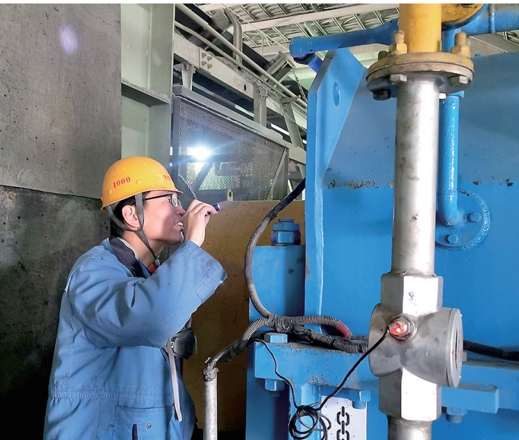
尖山铁矿选矿部斜井作业区设备副主管宋开贺,在开展党史学习教育活动以来,坚持做学史力行的践行者,他每天行走于现场的设备之间,用他的机械设计制造及其自动化专业解决设备难题。图为他认真检查A36减速机设备润滑情况。杨辉摄
