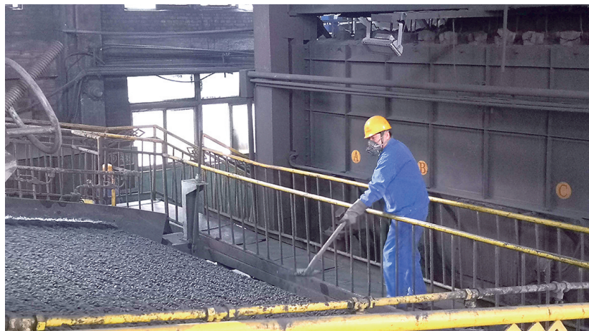
为进一步提升球团矿质量,打造用户满意产品,太钢代县矿业公司凝聚全员共识,提高全工序协同意识,使精细操作、工序服从理念体现到每个操作中。图为职工正在对生球进行取样。 刘艳云 摄
