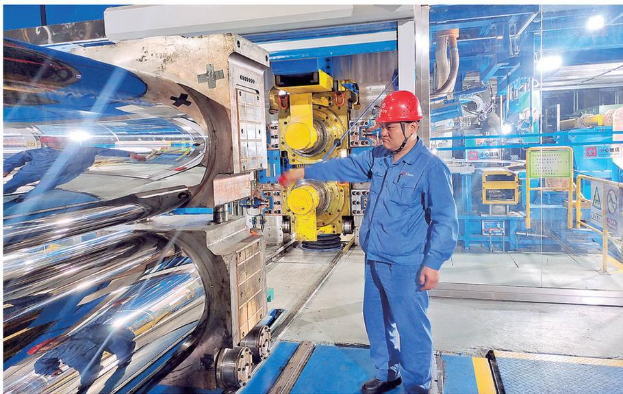
太钢不锈钢冷轧厂开展杜绝划伤、辊印减半专项行动以来,针对日常出现的辊印、划伤等质量问题,积极对标找差,严格要求岗位职工按照工艺标准进行规范操作,深挖影响产品质量的关键点,进一步优化质量管理体系,不断夯实质量基础管理,确保产品质量稳定始终如一。图为职工正在清理平整辊表面。
