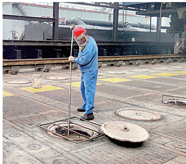
正值高温酷暑,焦炉炉顶环境温度达到50摄氏度左右,为保证生产顺利进行,提高焦炭产量,需要每日对炉口进行维护。图为太钢焦化厂岗位职工在做安全防护的情况下进行作业。 张彩锋 摄
