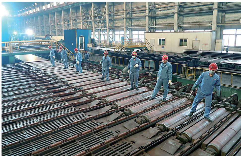
为进一步提高钢板表面实物质量,太钢不锈钢热轧厂成品作业区精整工序接班前都会对冷床每一根大链进行检查,及时更换磨损严重的链节和滑轮,减少了表面划伤。图为班组职工正在对大链进行检查。
