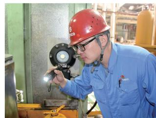
检修期间,韩向飞作为检修组长带领团队成员开始了一次全面检查。他发现转子中心与汽缸一侧已经有碰磨痕迹,这不能掉以轻心,因为汽轮机动静碰磨会引起重大安全事故。通过全面复核测量,他发现转子中心与汽缸中心同心度偏差较大,他迅速着手、测量计算,最终找到了工序简单、安全系数高的汽缸中心调整方案。检修后的汽轮机一次开机成功,且各轴瓦振动良好,同心度偏差均不超过0.03mm。
