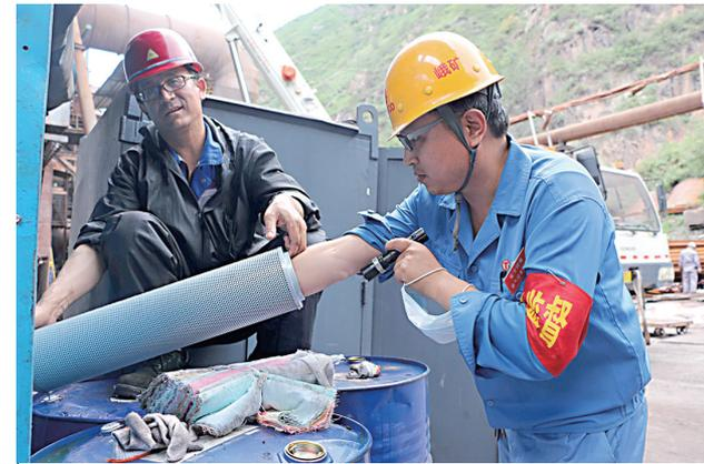
近日,太钢代县矿业公司严把系统检修质量关,除对检修队伍进行资质审核外,加强检修过程管控,对项目逐项进行验收,确保质量合格不返工。图为该公司设备技术员正在对冲洗后的液压马达管道滤芯进行检查,确认是否有杂质存在。
