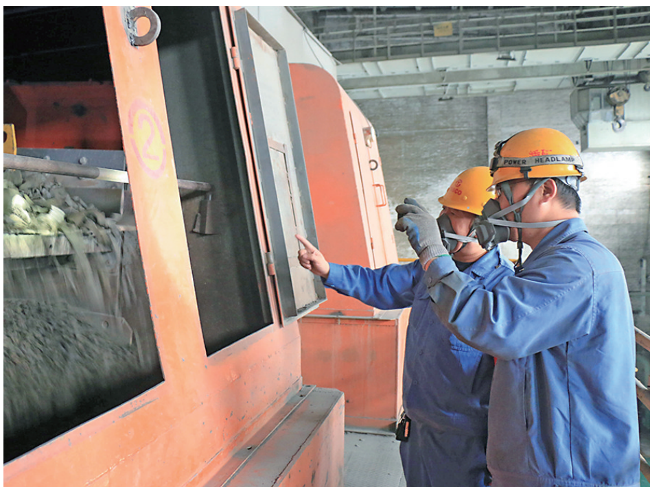
太钢代县矿业公司破碎作业区全面加强质量提升工作,对影响原料入磨四精品位和粒度指标的主体设备振动筛筛片、筛网及破碎机排矿口等加强定期监测,确保设备功能精度合格,保障生产工艺质量水平稳定。图为该作业区技术人员在进行筛网效果跟踪。 赵瑞文 摄
