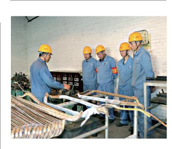
为了切实提高现场安全执行力和控制力,太钢代县矿业公司检修中心检修三队电修班周三安全活动"三讲"培训到现场,并与"员工上台讲安全"活动紧密结合,直观面对实物讲流程、讲风险、讲措施,切实使周安全活动起到提升职工操作技能、促进员工标准作业的作用。图为电修工认真讲解同步机高压线圈热压成型制作过程的每一个步骤、存在的隐患及相应的防范措施。
