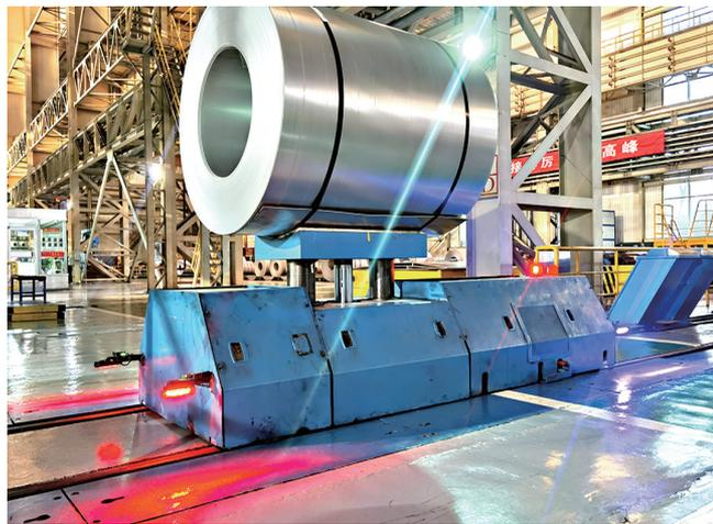
现了运卷小车自动过跨、自动放卷,遇到通行人员自动停车保护等功能。在运卷小车四个边角位置,加装了“一字灯”,画出灯光“警示线”,提醒来往人员和车辆注意避让,加装了“过跨小车通行,人员请避让”的语音提示,起到声光报警的作用,同时增加红外线感应装置,遇到人员违规通行时,也能启动联防联控信号,小车会自动停车。通过一系列智能化、人性化的改进确
