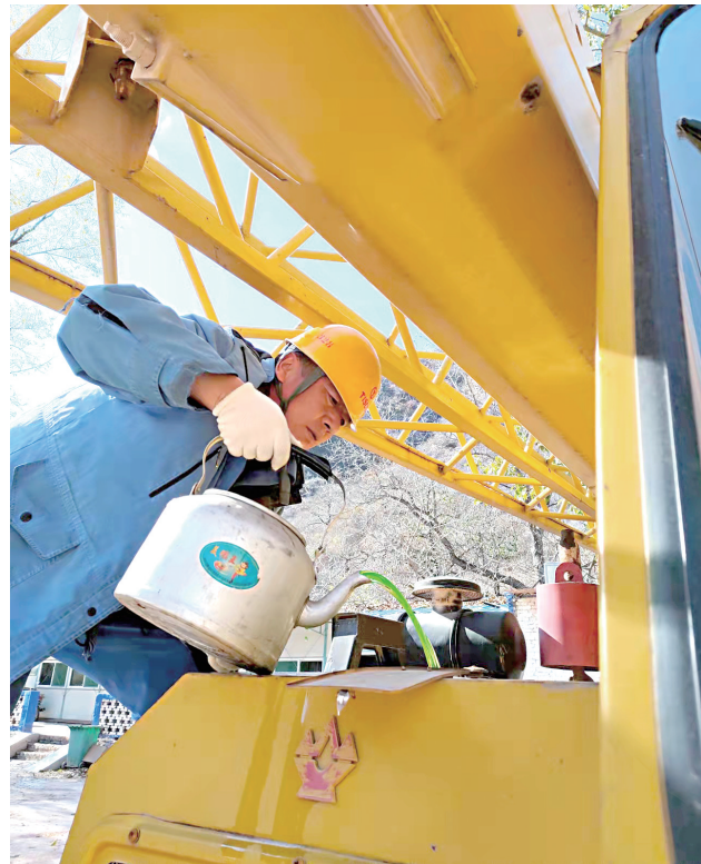
近日,太钢复合材料厂复合作业区认真做好冬季防冻保温工作,对车辆设备进行了换季保养,确保爆场冬季安全生产。图为作业人员在为吊车更换防冻液。 郝枝平 摄
