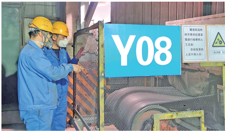
进入四季度以来,为进一步强化工艺质量稳定,为下工序输送优质铁精矿粉,太钢尖山铁矿选矿部磨选作业区对上工序的原矿来矿情况进行详细查看,对矿石的颗粒大小进行研判,随时调整台时,确保矿粉品位达标。 杨 辉 摄
