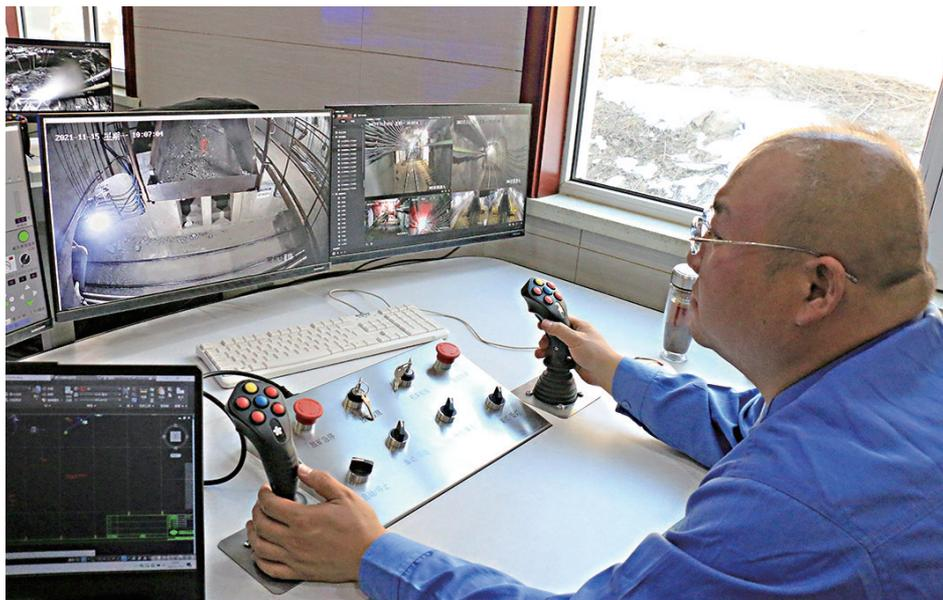
近期,太钢代县矿业公司全面落实中国宝武智能制造“四个一律”要求,着力打造地下智慧矿山建设,攻坚克难完善了地采生产电机车远程操作优化与功能改进,完美实现电机车无人驾驶稳定运行目标,改善了职工工作环境。图为该公司电机车岗位职工在专心致志进行远程驾驶操作。 赵瑞文 摄
