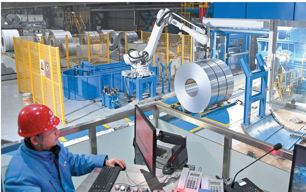
太钢以“四个一律”即“操作室一律集中、运维一律远程、服务环节一律上线,操作岗位一律机器人”为目标,全力加强智慧化建设,推进智慧钢铁进程,有效减轻了职工劳动强度,美化了工作环境,增强了安全保障,提高了工作效率。图为太钢不锈钢冷轧厂智能拆捆机器人在进行生产作业。王旭宏 摄 郭玮 文
