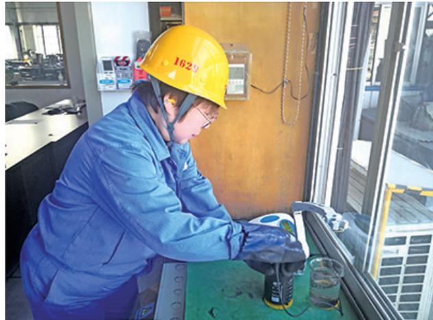
为保障铁精矿粉的输送质量,稳定铁精矿粉的PH值,太钢尖山铁矿成品动力部按制度定期对铁精矿粉进行取样检测。图为当班职工对随机取样铁精矿粉进行检测。 郑惠摄
