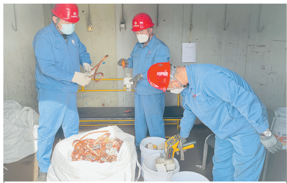
太钢加工厂认真践行绿色发展理念,对回收的各类废旧物资实行精细化分类管理,分选出高价值贵金属交付钢厂进入炼钢工序循环使用,为公司实现降本增效、绿色发展助力。图为该厂落锤作业区废旧物资回收组职工分选作业现场。李鹏 摄
