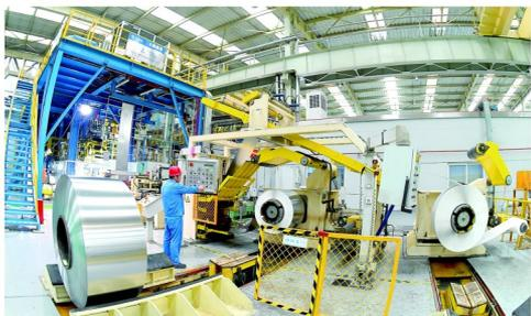
超薄精密不锈钢带钢是钢铁尖端产品,是5G通讯、航空航天安全装置、防辐射服、新能源、高端电子等高科技新兴领域不可或缺的关键材料。近年来,随着消费类电子产品的快速发展对于宽幅超薄不锈钢精密带钢提出了迫切需求。太钢坚持自主创新,通过产—学—研结合,历经10年上千次试验实现了钢质纯净度、精密控形轧制、高性能控制和关键装备等方面的重大创新,首次开发出世界上最薄、最宽、性能最优的不锈钢精密带钢,技术和产品质量达到世界领先水平。太钢宽幅超薄不锈钢精密带钢工艺技术引领了世界不锈钢超薄带钢的发展方向,代表了钢铁行业尖端制造水平,促进不锈钢冷轧产品向更薄更宽方向拓展。
